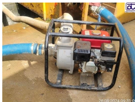
รูปที่ 2-27 เครื่องสูบน้ำสำรองที่จัดเตรียมไว้ในบริเวณพื้นที่ก่อสร้าง
