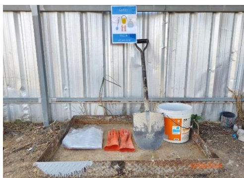
รูปที่ 2-24 วัสดุดูดซับ กรณีเกิดการรั่วไหลของน้ำมันและสารเคมีต่าง ๆ
