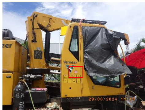
รูปที่ 2-10 สตีกเกอร์แสดงการตรวจสอบสภาพเครื่องมือ เครื่องจักร และเครื่องยนต์
