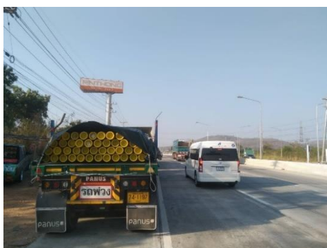
รูปที่ 2-7 การปิดคลุมรถบรรทุก และผูกมัดวัสดุและอุปกรณ์ก่อสร้างเพื่อป้องกันการตกหล่นขณะขนส่ง
