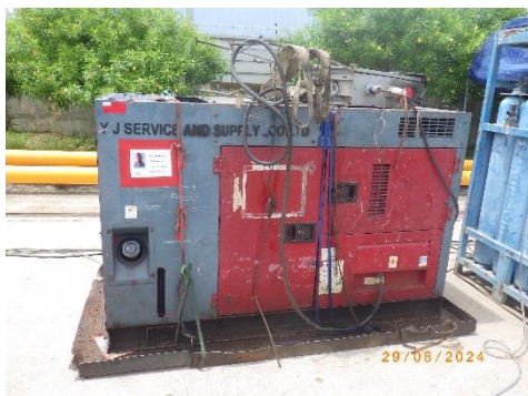
รูปที่ 2-10 สตีกเกอร์แสดงการตรวจสอบสภาพเครื่องมือ เครื่องจักร และเครื่องยนต์
